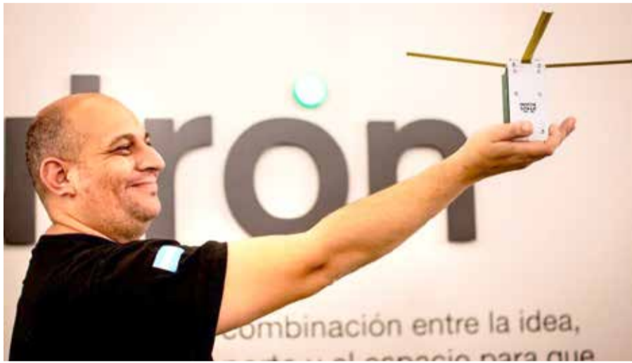
El «MDQube-SAT1», mejor conocido como “General San Martín” es un picosatélite (término que significa satélite de tamaño chico) primero en su tipo en toda Latinoamérica. Pesa solo medio kilogramo y mide 10 cm por 5 cm por 5 cm.
